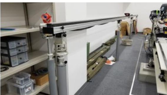
光波測距儀の位相を検査
